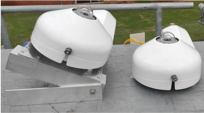
Fig. 2 Piranômetros CMP10 global horizontal e no plano inclinado na latitude (Acervo LABENS, 2020).
