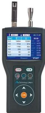
Fig. 3: Contador de partículas óptico utilizado nas medições
