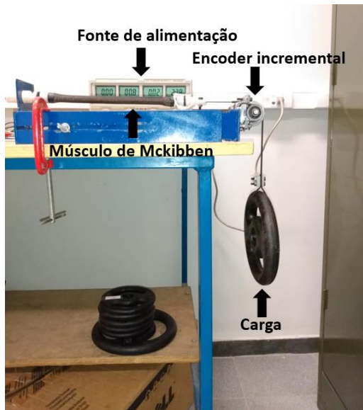
Fig. 4. Bancada experimental utilizada para a CDI.
