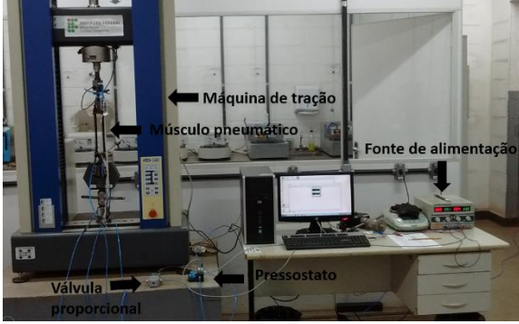
Fig.3. Máquina de tração utilizada para as caracterizações isométricas.
