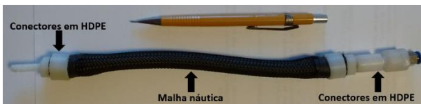
Fig. 1. Músculo de Mckibben desenvolvido, com destaque para seus principais componentes.
