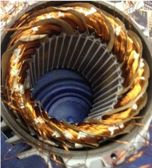
Figura 5. Estator com todas as bobinas dispostas.
