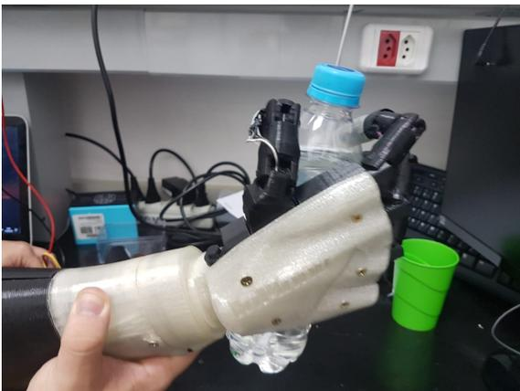
Figura 8. Prótese segurando uma garrafa PET de água de 600 ml.
