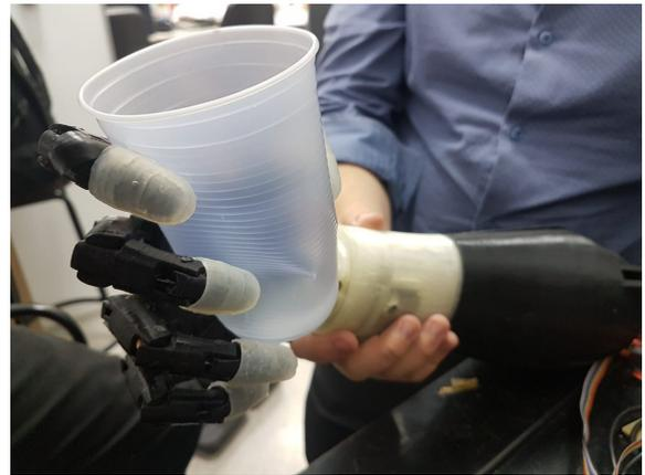
Figura 12. Prótese segurando copo descartável de plástico de 200ml.
