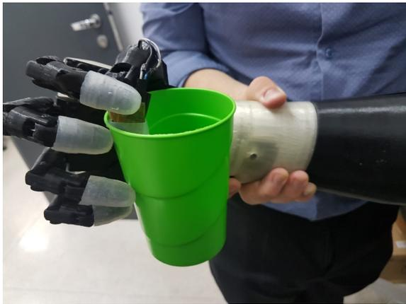
Figura 10. Prótese segurando copo plástico de 200 ml.
