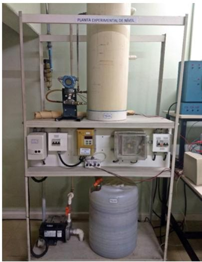
Fig. 2. Planta Experimental de Nível
