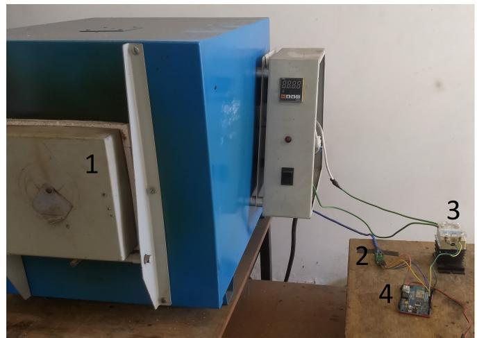
Figura 1. Forno mufla (1) e controlador (2 a 4) implementado por Miranda & Fernandes (2019). Fonte: Miranda & Fernandes (2019).
