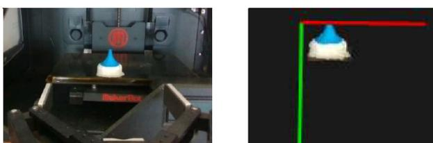
Figura 9. Imagem original vs bico dosador isolado na nuvem de pontos.
