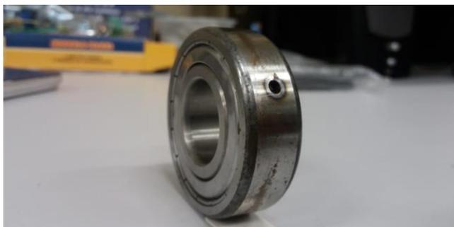
Fig. 6 Rolamento com furo na pista externa para simulação de defeito.
