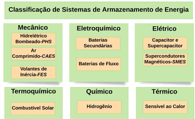
Figura 1. Classificação das tecnologias *ESS*
