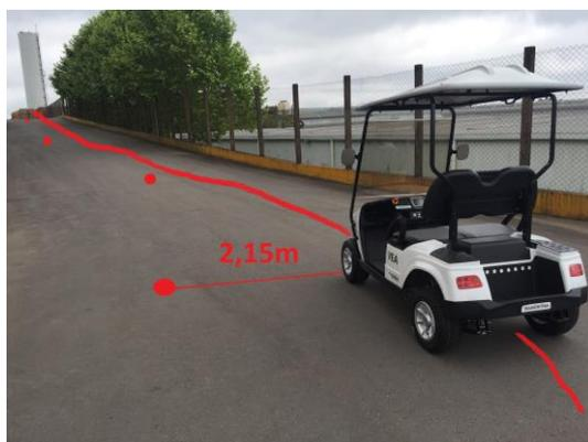
Figura 4: Análise do erro de deslocamento com o ponto da rota criada.
