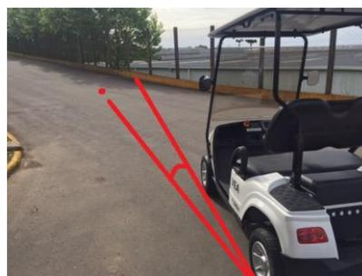
Figura 3: Ângulo calculado da direção do veículo através da bússola magnética eletrônica.
