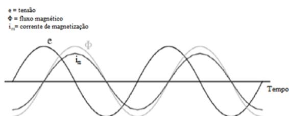
Figura 1. Defasagem entre formas de onda da tensão, do fluxo e da corrente de magnetização.
