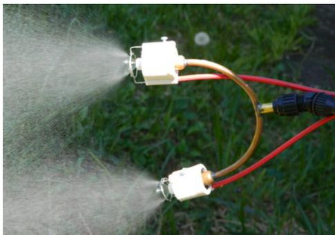
Figura 2. Bico com pulverização eletrostática.
