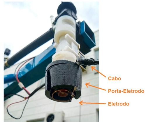
Figura 10. Bico pulverizador com eletrodo.
