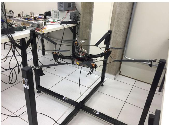
Fig. 2 Estrutura de Metalon para sintonia dos ganhos.
