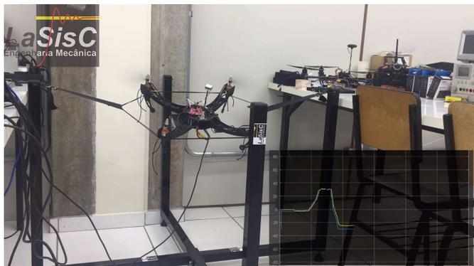
Fig. 4 Teste de calibração do movimento de arfagem. No canto inferior direito é demonstrada a telemetria em tempo real para tomadas de decisão.
