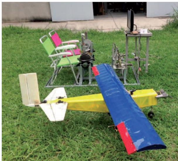
Figura 5: Primeiro protótipo da cabine de pilotagem em vista lateral, com uma aeronave preparada para voo. Foto retirada de (Torres and Morales, 2016).
