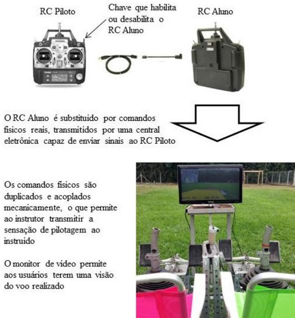
Figura 8: Diagrama do laboratório. A foto da cabine foi retirada de (Torres and Morales, 2016).
