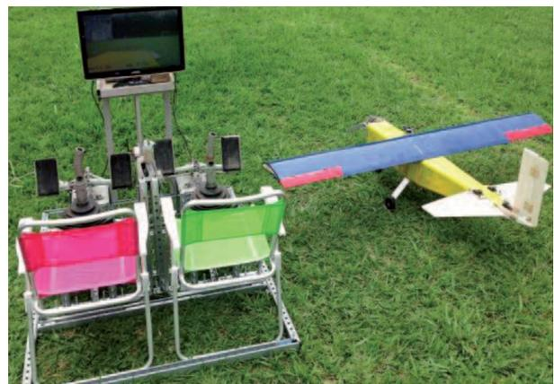
Figura 4: Primeiro protótipo da cabine de pilotagem, junto com uma aeronave preparada para voo. Foto retirada de (Torres and Morales, 2016).
