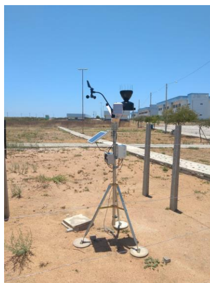
Fig. 2 Estação Meteorológica Automática da UFERSA Caraúbas.
