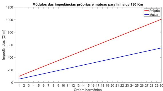
Figura 3. Impedância em função da frequência sem correção de comprimento.
