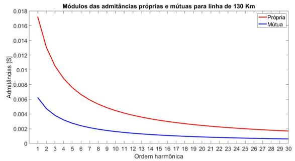
Figura 4. Admitância em função da frequência sem correção de comprimento.
