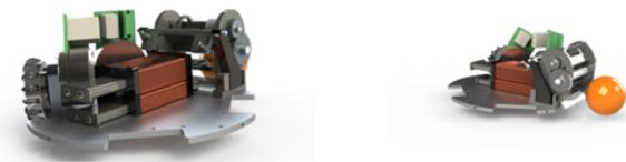
Figura 8. Sistema de chute (esquerda) e de drible (direita).
