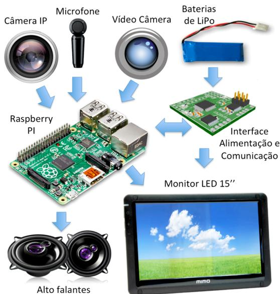
Figura 2. Diagrama do projeto final dos circuitos e periféricos da cabeça do robô desenvolvido.
