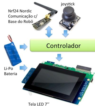
Figura 6. Diagrama do controle remoto do robô desenvolvido.
