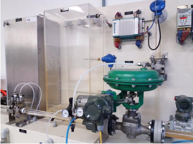
Figura 1. Válvula de controle de vazão instalada.
