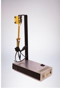
Figura 1. Foto do aeropêndulo com dois eixos de liberdade.
