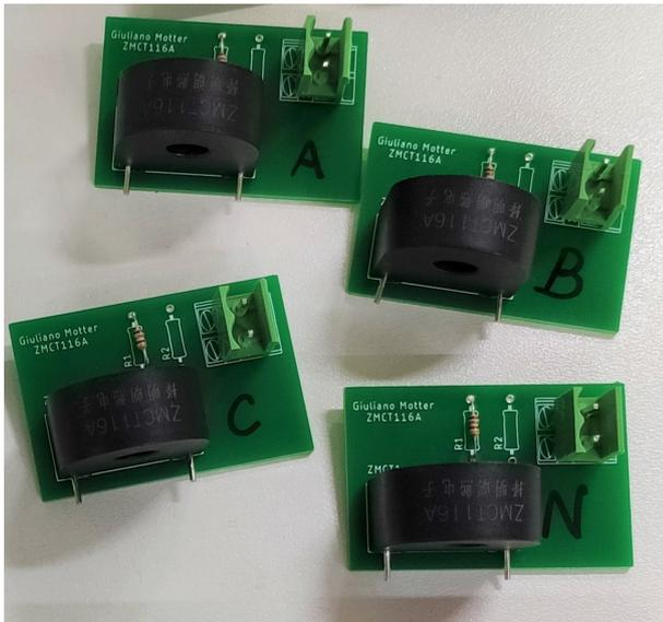
Figura 10. Placa de circuito impresso projetada e montada para os sensores de corrente.
