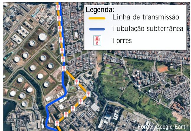
Figura 9. Traçado da LT e da tubulação metálica para o caso real.
