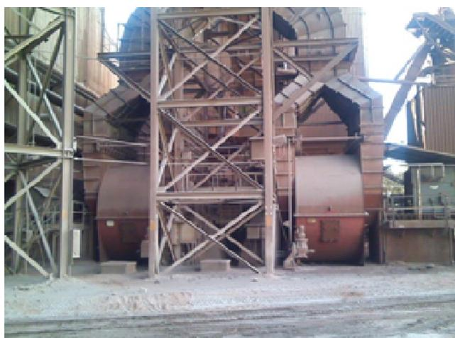
Figura 2. Ventiladores do Sistema de Despoeiramento
