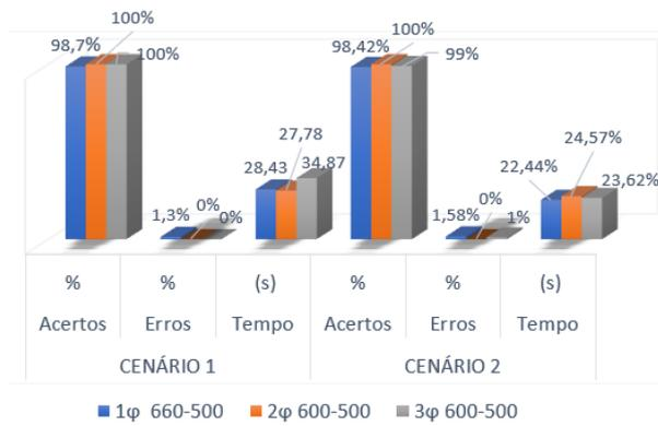
Figura 7- Resultados das simulações para detecção de faltas de curto-circuito para os cenários 1 e 2.
