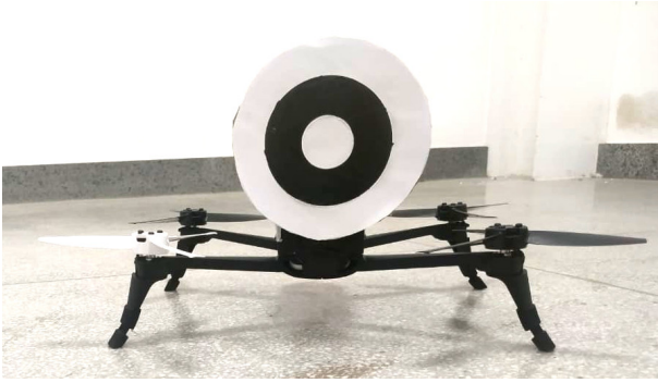
Figura 5. Marcador preto e branco acoplado ao líder para ser usado pelo seguidor para manter a distância desejada t_{des} .
