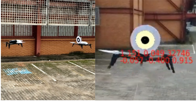
Figura 1. Os dois quadrimotores Parrot Bebop 2 navegando em um ambiente externo utilizando apenas os sensores a bordo e câmera monocular (esq.); bem como um snapshot do algoritmo de visão utilizado no robô seguidor (dir.).
