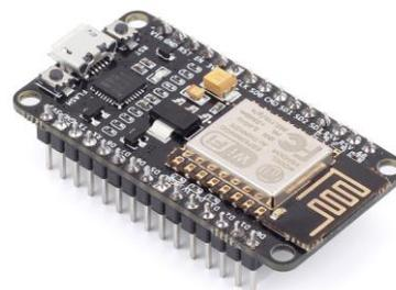
Figura 3. ESP8266 NodeMCU.
