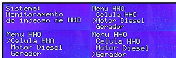
Figura 6. Interface em display LCD contendo o menu do sistema de monitoramento do gás de eletrólise.
