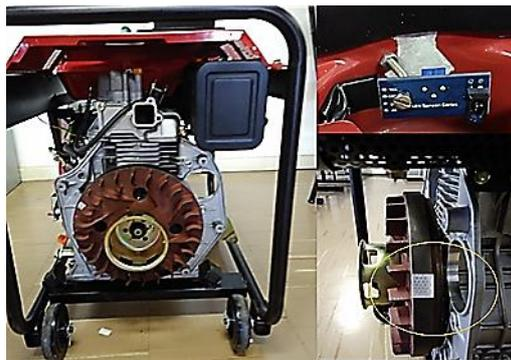
Figura 3. Instalação do sensor TCRT 5000 no volante do motor a diesel
