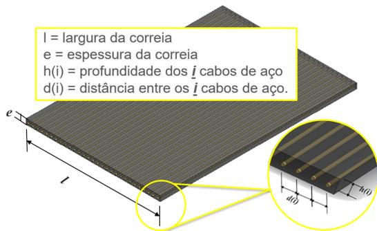
Figura 2. Dimensões da correia e localização interna dos cabos de aço.
