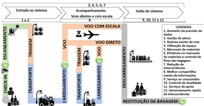
Figura 2: Ilustração esquemática do itinerário e fluxo das bagagens nos aeroportos, pontos de fiscalização obrigatórios e a inclusão da tecnologia RFID. Fonte: os autores.
