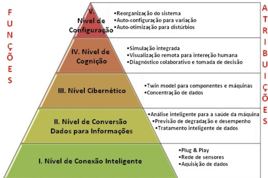
Figura 1: Arquitetura CPS 5C. Fonte: Adaptado de (Lee et al., 2015)
