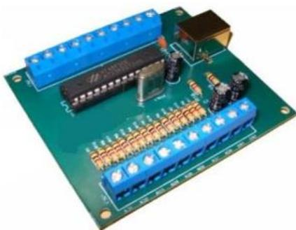
Figura 1. Placa de aquisição de dados
