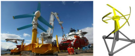
Figura 7. Exemplos de turbinas de eixo horizontal e de eixo vertical (Sleiti, 2017).
