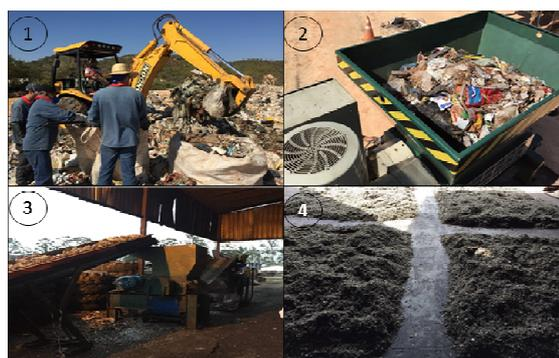
Figura 2. Coleta e preparo das amostras: 1- Ponto de coleta; 2- Primeira etapa de trituração; 3- Segunda etapa de trituração; e 4- Quarteamento da amostra (granulometria 10 mm).
