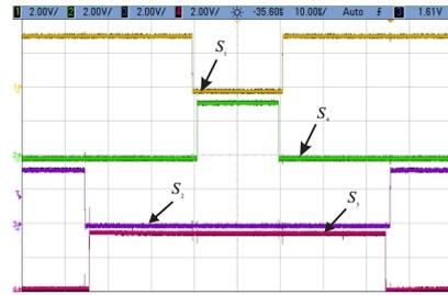
Figura 4: Resultado experimental da sequência de chaveamento das chaves ( $S_1$ ,  $S_4$ ,  $S_2$  e  $S_5$ ) para  $v_{1r}^* > 0$ ,  $v_{2r}^* < 0$  e  $v_{3r}^* > 0$ .
