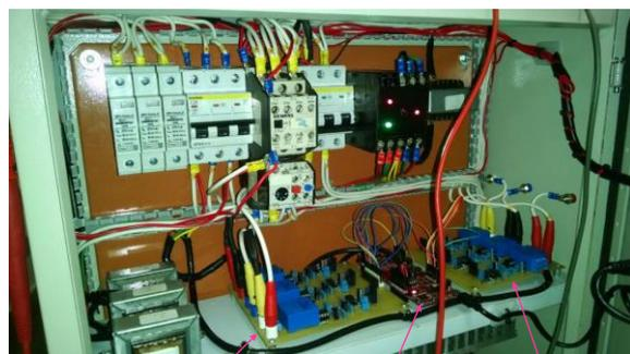
Processamento Analógico de Tensão      Microcontrolador      Processamento Analógico de Corrente
