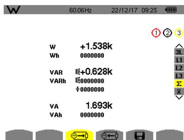
Figura 14. Potência equivalente carga mais compensador.
