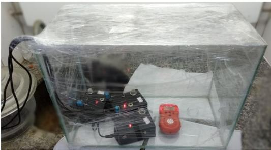
Figura 7: Ambiente de calibração do MQ-135
