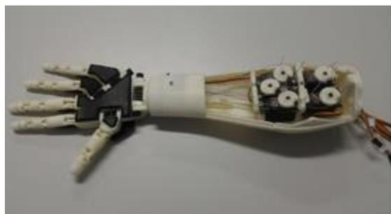
Figura 5. Conexão e fixação dos servos na prótese InMoov.
