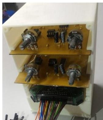
Figura 6. Circuito amplificador de biopotencial.
