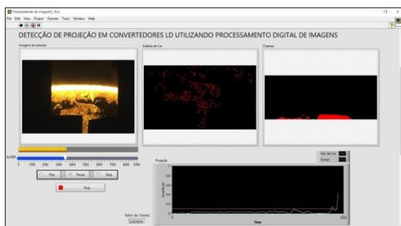
Figura 8 - Programa de processamento de imagens desenvolvido em LabVIEW.
