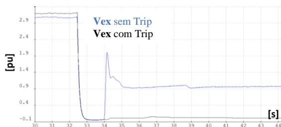
Figura 9. Tensão de Excitação (Vex) com Trip (Preto) e sem Trip (Azul) pela Função 59I
