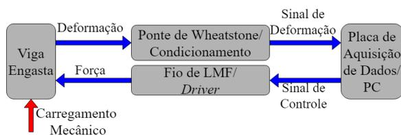
Figura 3: Diagrama de blocos do sistema implementado para realizar o monitoramento e o controle da deformação da viga.
