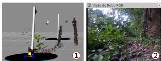
Figura 7: Ambiente de visualização Rviz e visão do veículo no ambiente *outdoor*: (1) Projeção tridimensional do ambiente; (2) Imagem da câmera do Kinect.
