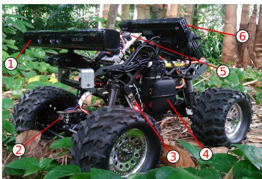
Figura 5: Vista em perspectiva do protótipo: (1) MS Kinect; (2) Sensor do ângulo da direção; (3) Fonte 5V DC e (4) Placa Raspberry PI; (5) MCU; (6) Monitor.
