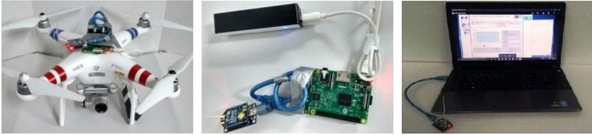
(a) VANT Phantom 3 Standard com sistema embarcado. (b) Sistema embarcado Raspberry Pi 3, módulo XBee e bateria. (c) Estação Base equipada com módulo XBee.
