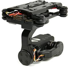
Figura 3: Gimbal de 3 eixos usado nos experimentos conduzidos.
