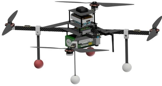
Figura 1: SARP de pequeno porte do tipo quadricóptero construído visando estabilidade, tempo de voo e baixo custo.
