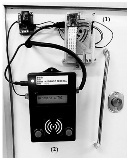
Figura 4. Protótipo do sistema de controle de acesso.
