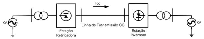
Fig. 1. Diagrama unifilar genérico de um sistema de transmissão HVDC.
