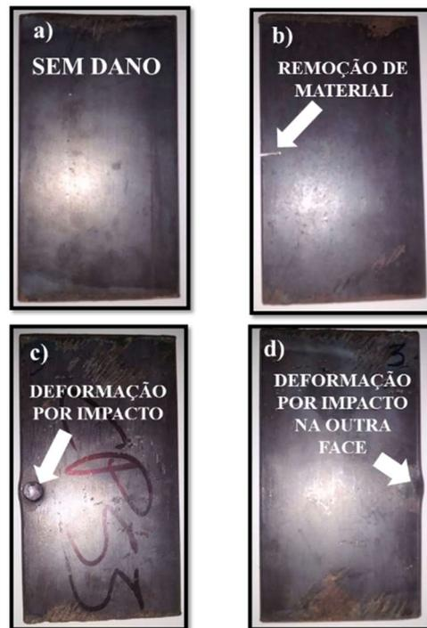
Figura 3. a) Peça metálica referente à classe SD. b) Peça metálica referente à classe RMI. c) Peça metálica referente à classe DI. d) Peça metálica referente à classe DIPD
