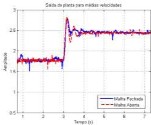
Figura 12. Teste prático para o sistema operando em médias velocidades.
