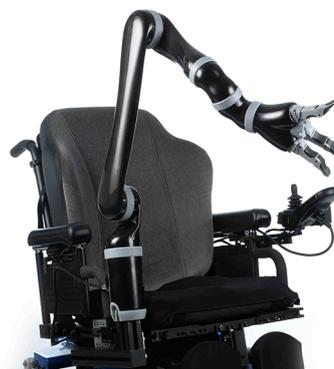
Figura 1: Manipulador JACO adaptado a uma cadeira de rodas
