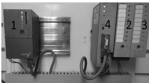
Figura 2. Configuração após o retrofit, CPU Speed 7 como um mestre de uma rede Profibus-DP(1), módulo de comunicação(4), entrada(2) e saída digital(3).
